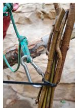
*Photo : Les tire-câbles sont fixés avec des mousquetons de sécurité. Les branches regroupées avec des serre-câbles réutilisables y sont également suspendues.*
