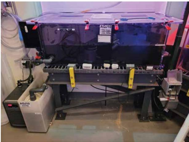
Photo 2 : Installation d'exposition avec éclairage LED au-dessus, réservoir avec couvercle fermé, filtre, puisard avec bio-billes et refroidisseur d'eau Artica.
